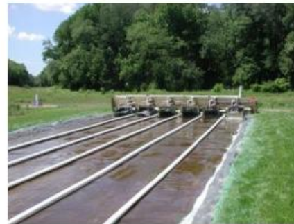
Figur 2. Til venstre ses solcellerne der driver pumpen til cirkulation af drænvandet ovenpå gummipladerne (billede højre) (Kangas & Mulbry, 2014b).
